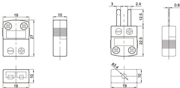
为了便于热电偶和补偿导线的联接，或者热电偶与温度仪表的联接，国际上统一规定了热电偶插件的标准，常用分为大和小插头2种。
