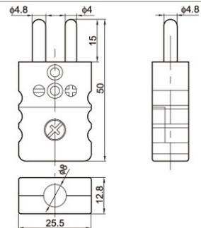
为了便于热电偶和补偿导线的联接，或者热电偶与温度仪表的联接，国际上统一规定了热电偶接插件的标准，常用分为大和小插头2种。
