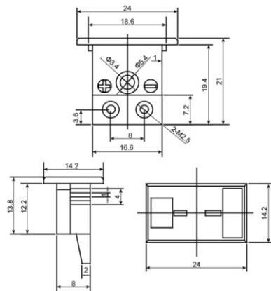
为了便于热电偶和补偿导线的联接，或者热电偶与温度仪表的联接，国际上统一规定了热电偶接插件的标准，常用分为大和小插头2种。
