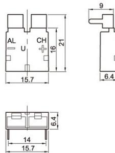
为了便于热电偶和补偿导线的联接，或者热电偶与温度仪表的联接，国际上统一规定了热电偶接插件的标准，常用分为大和小插头2种。
