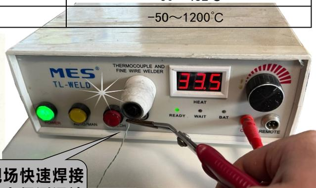
现场快速焊接热电偶测温端
