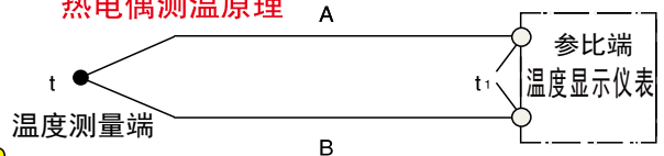
热电偶测温原理
