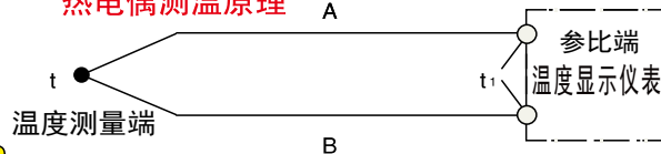
热电偶测温原理
